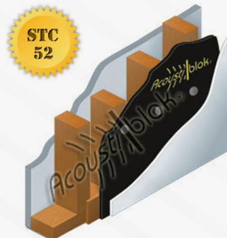
Sobre tabique de madera
